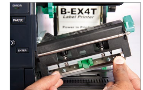
Het printkopkliksysteem beperkt de onderhoudsduur tijd tot het minimum
